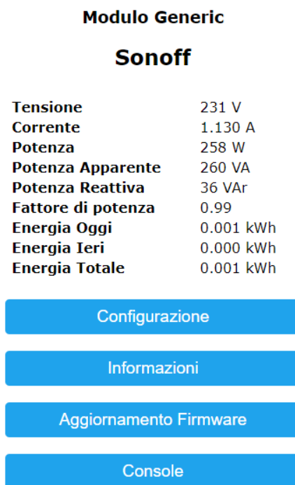
Figura 4.3. Monitoraggio di corrente tramite l'interfaccia web di Tasmota
