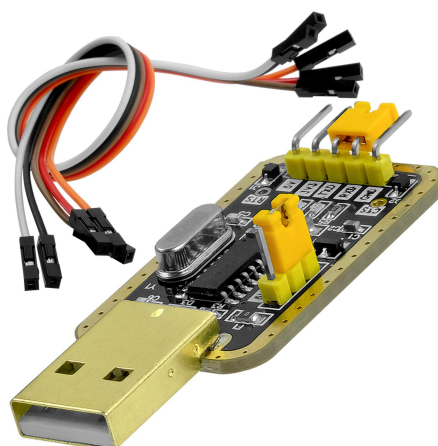
Figura 4.5. Adattatore USB da UART a TTL basato su chip CH340G [2]
