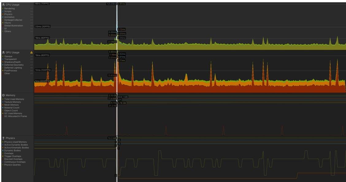
Figura 6.4. Contenuto della schermata dell'Analyzer di Unity in corrispondenza del momento in cui avviene il caricamento delle nuove porzioni di terreno e la de-allocazione di quelle più lontane.
