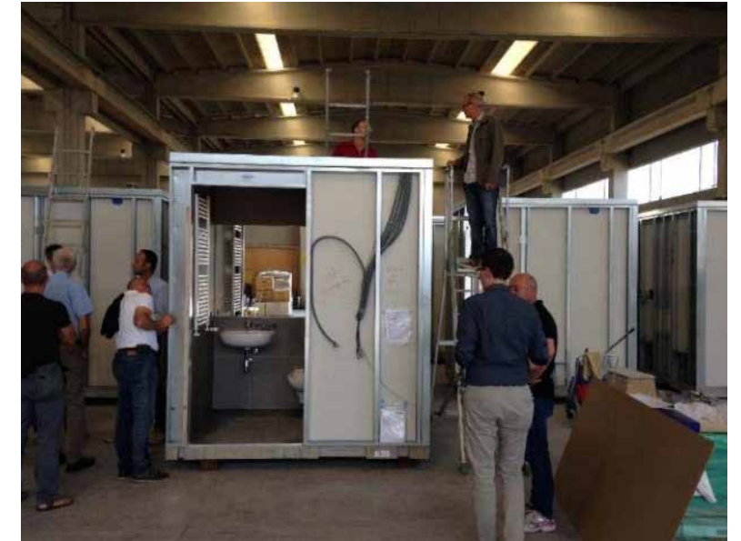
fig 80: moduli bagno realizzati in stabilimento fonte: Massimo Scartezzini. (2018). La residenza Universitaria Mayer—Trento Il progetto tra architettura e struttura. Ciclo di seminari tecnici, fabbricalegno.
