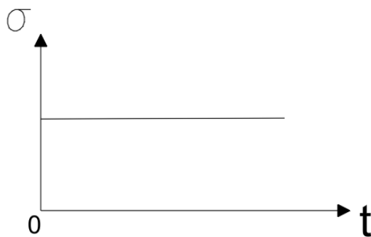
Figura 31: Andamento tensione di precompressione nel tempo
