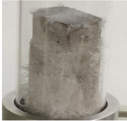
Figura 16. 1,10-fenantrolina ricristallizzata sul fondo del reattore di pirolisi.
