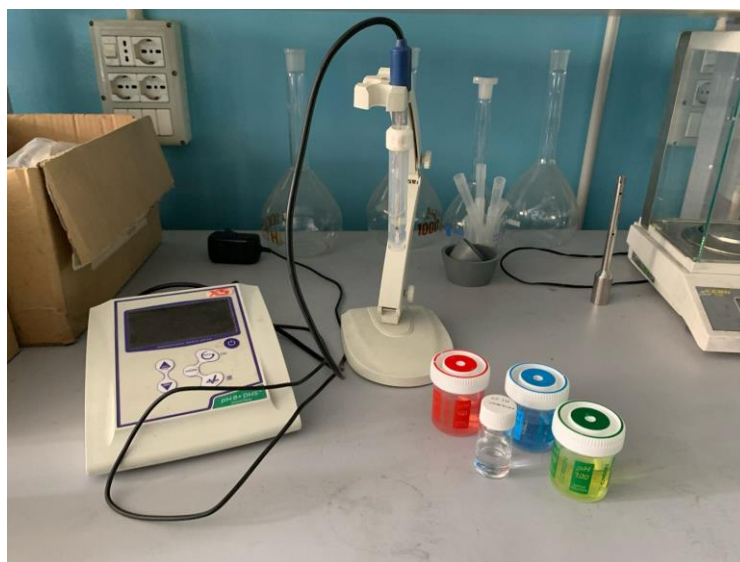
Figura 4-2: pHmetro utilizzato per le misurazioni con soluzioni di calibrazione (verde pH = 7, rossa pH = 4.01, blu pH = 10) e liquido per la conservazione (KCl 3M).
