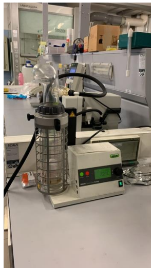
Figura 4-8: Insieme di apparecchiature per il trattamento di elettrodi e separatori costituita dal fornello programmabile Buchi ® Glass Oven B-585 (davanti) e la pompa da vuoto modello Buchi ® V-300 (dietro).
