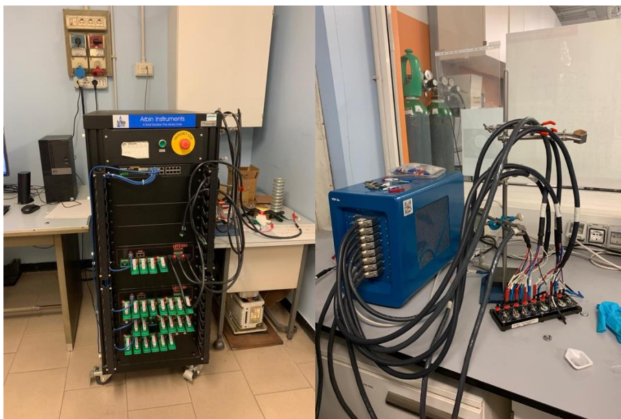
Figura 4-12: Galvanostato multicanale BT-2000 ® della Arbin Instrument (a sinistra) e potenziostato multicanale VSP-3e ® della Biologic (a destra).
