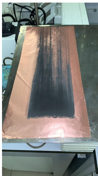
Figura 5-5: Applicazione dello slurry costituito da CG al 4% in peso su foglio di rame.
