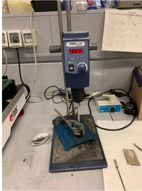
Figura 4-4: Esempio di miscelazione dello slurry a 2200 rpm. Il miscelatore è un agitatore meccanico ad asta con display LED modello AM20-D di ARGOLab®. Utilizzato con elica che permette un flusso assiale con suzione verso l'alto e la comparsa localizzata di forze di taglio.
