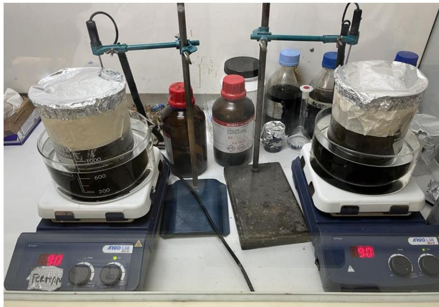
Figura 48: Scale up idrolisi acida.
