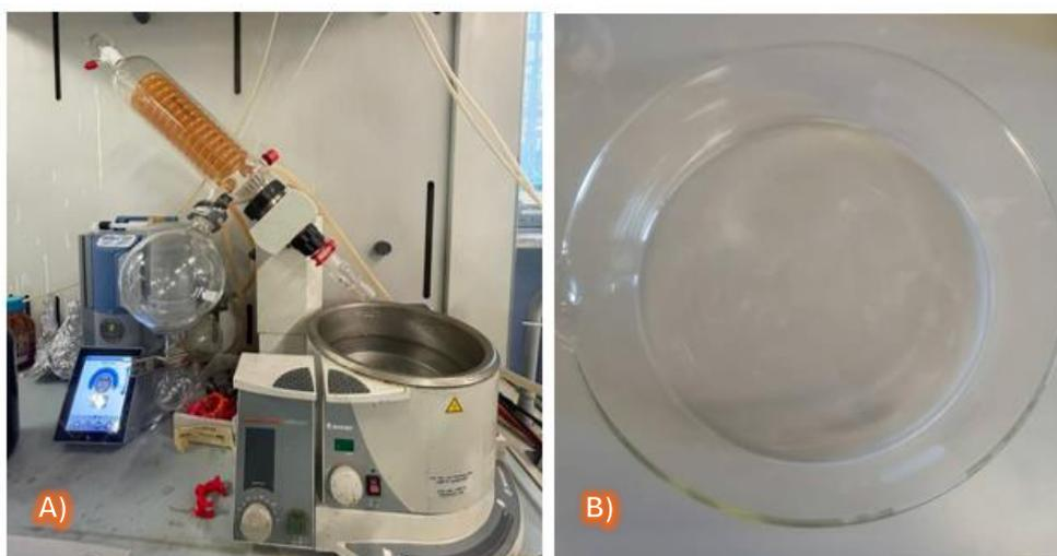
**Figura 34:** A) Evaporatore rotante Heidolph LaboRota 4000/ HB Efficient,
