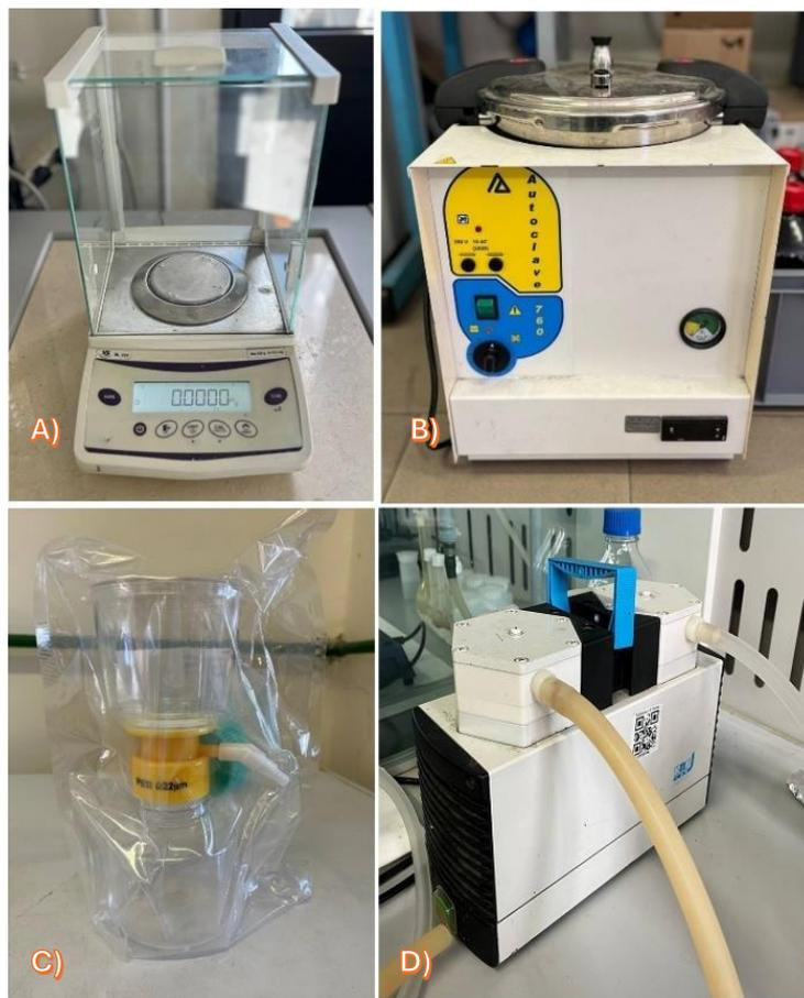
**Figura 30:** A) Bilancia analitica di precisione digitale XS BALANCE BL 224, B) Autoclave sterilizzatore a vapore da banco 760 Savatec, C) Sistema di filtrazione sottovuoto GVS filter technology, D) Pompa per vuoto a membrana KNF laboport.
