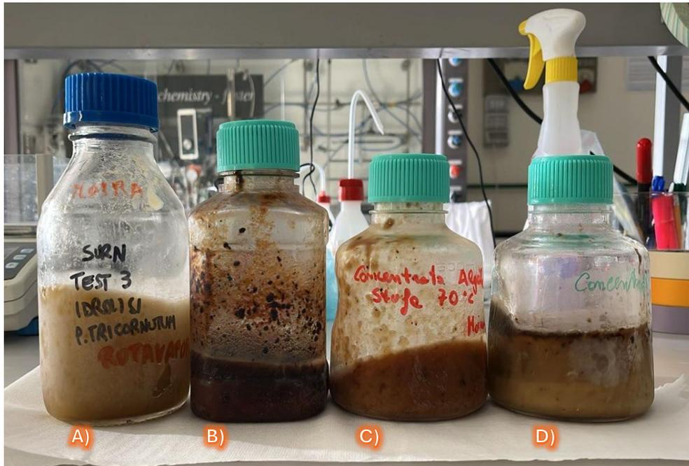
**Figura 64:** Concentrato algale ottenuto con: A) Evaporatore Rotante, B) Stufa 90 [°C], C) Stufa 70 [°C], D) Stufa 65 [°C].
