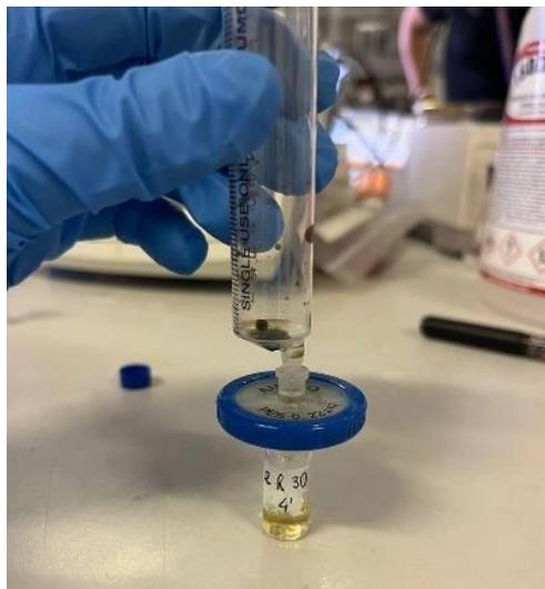
**Figura 45:** Filtrazione tramite PES per analisi HPLC.
