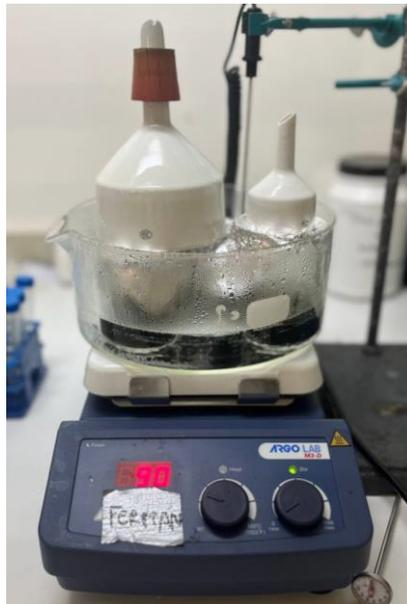
**Figura 43:** Dettaglio estrazione zuccheri con idrolisi acida.
