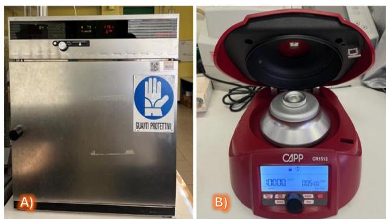
**Figura 32:** A) Forno universale a convezione naturale Memmert, B) Mini centrifuga CAPP Rondo CR-1512.
