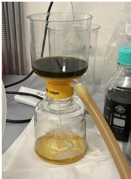
**Figura 50:** Filtrazione sottovuoto dell'idrolizzato algale.
