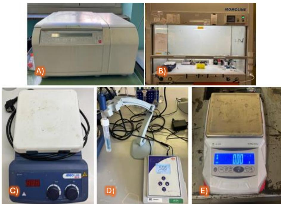
**Figura 31:** A) Centrifuga Thermo Scientific SL 16R, B) Cappa chimica MOMOLINE E220, C) Agitatore magnetico digitale a microprocessore con piastra riscaldante ARGOLab M3-D, D) Phmetro da banco XS pH50+ DHS, E) Bilancia di precisione digitale XS BL 2002.
