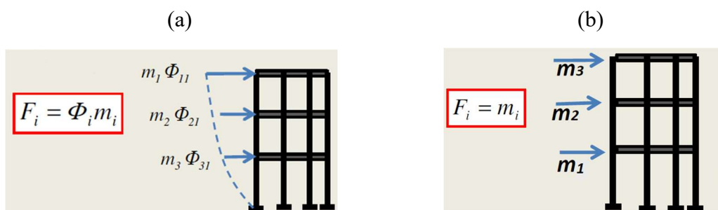
Figura 2.5 - Determinazione dei profili di forze (a) modale e (b) uniforme [19].
