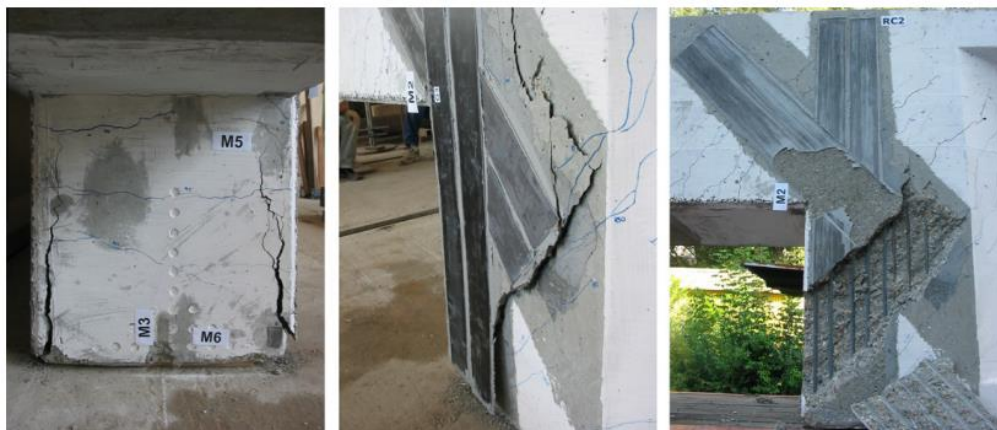
Figura 15: Immagini che evidenziano il distacco delle piastre CFRP verticali e inclinate di una delle selle testate [21]
