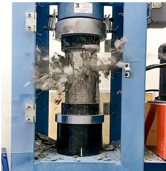
*Figura 20 Misurazione resistenza calcestruzzo*
