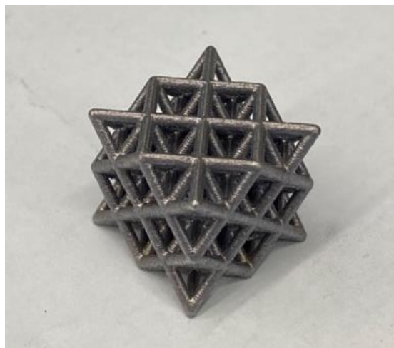
Figura 3. Provino in esame: cella lattice 2x2 in alluminio, stampata tramite SLM
