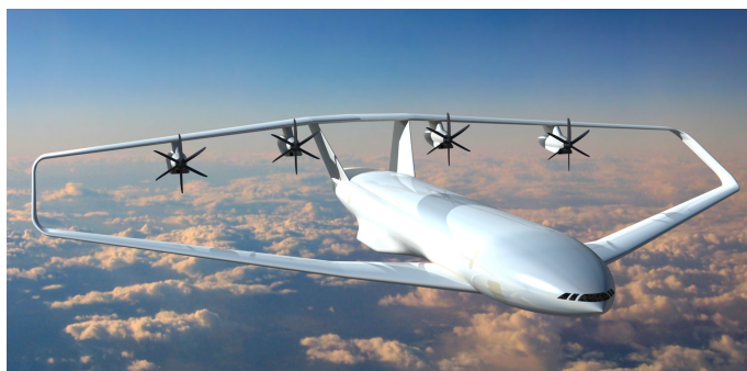
Figura 1.3: Rappresentazione artistica di un velivolo con ala anulare 'alla Prandtl'
