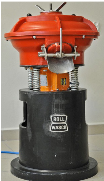
Figura 30. Buratto modello Rollwasch SMD-25-R con molle ben visibili.
