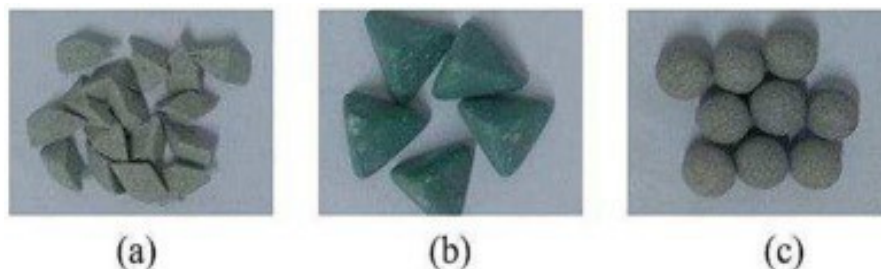
Figura 31. Tre esempi di media utilizzati: SiC a forma quadrangolare di lunghezza 6 mm (a), resina triangolare di 12 mm di lunghezza (b), corindone sferico di 12 mm di diametro (c).
