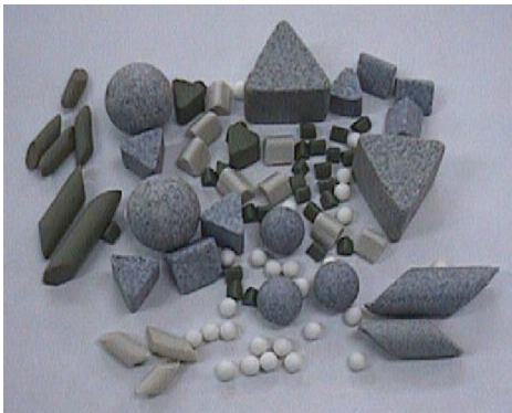
Figura 27. Esempi di media di granulometrie differenti in forma e dimensioni [93].
