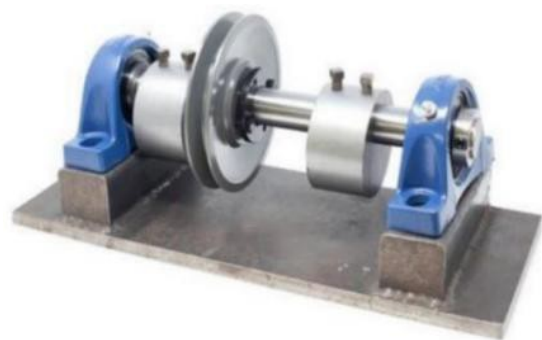
Figura 28. Gruppo albero completo con cuscinetti e masse eccentriche [101].
