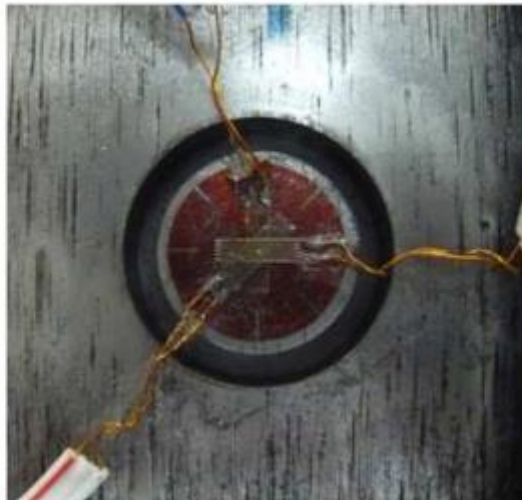
Figura 2.4: rosetta estensimetrica per la misurazione della deformazione del foro [5].
