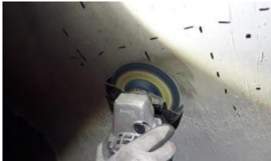
Figura 34 - Smerigliatura della superficie per la posa degli estensimetri [10]
