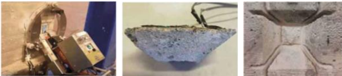
Figura 32 - Sx: applicazione prova di rilascio troncoconica - Centro: elemento troncoconico estratto - Dx: cls privo di elemento troncoconico [10]
