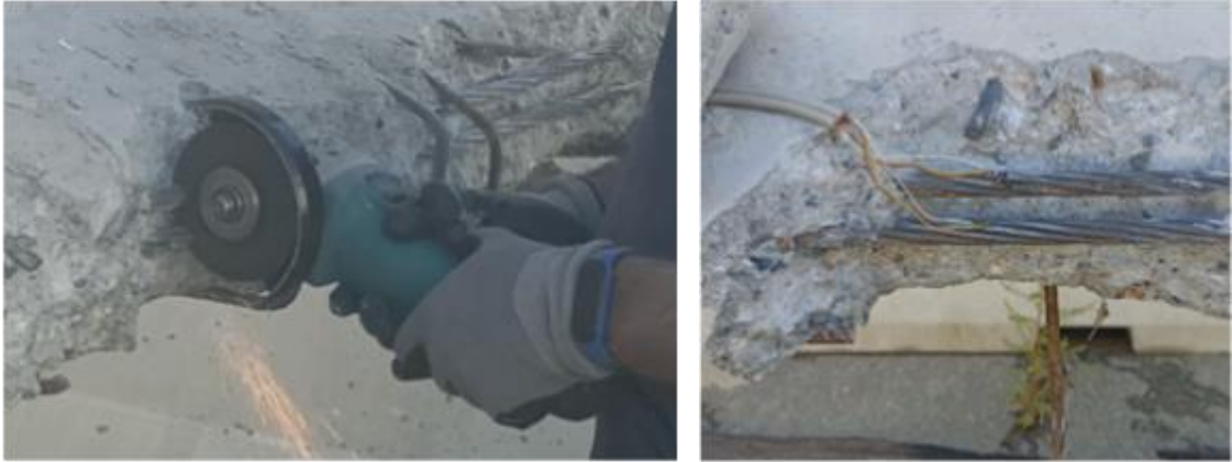
Figura 28 - Sx taglio del trefolo - Dx applicazione strain gauge
