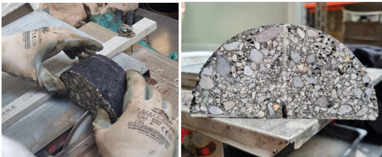
Figura 68: sx) formazione dell'intaglio; dx) campione SCB completato;
