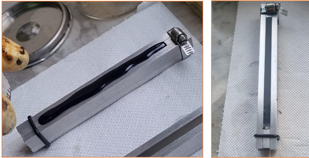
Figura 33: sx) Travetto di bitume prima della fase di “trimming”, dx) travetto dopo la fase di “trimming”;
