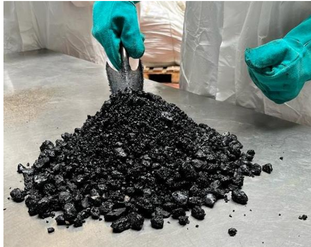
Figura 60: formazione del cumulo conico
