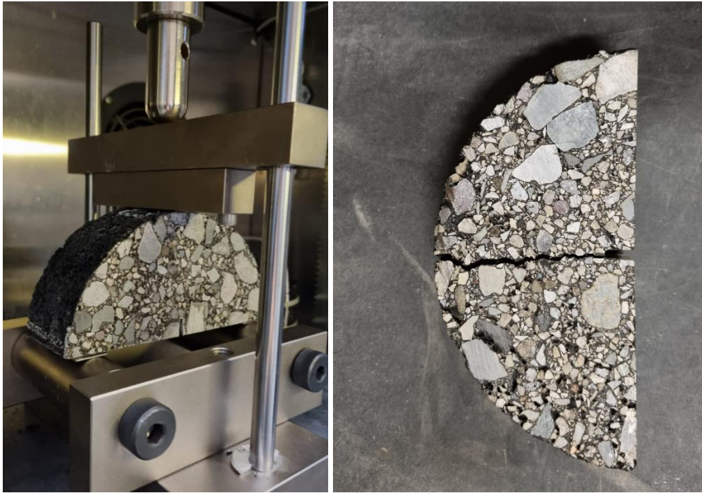
Figura 71: sx) campione in posizione; dx) campione rotto (rottura valida);
