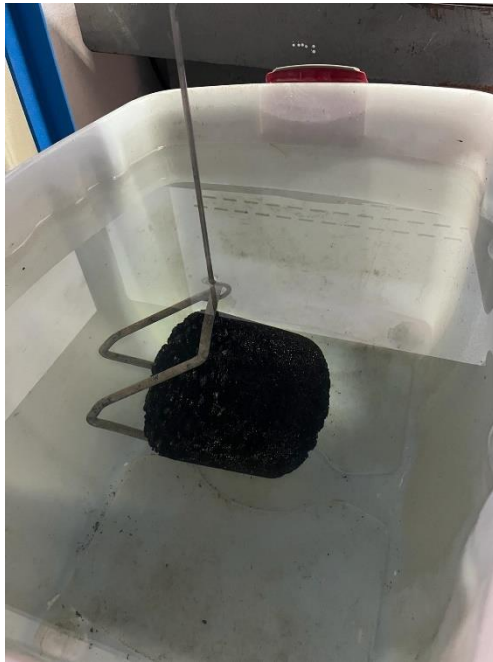
Figura 65: 1) peso del campione asciutto; 2) immersione del provino; 3) pesata in acqua; 4) fase di asciugamento del provino mediante panno in camoscio;
