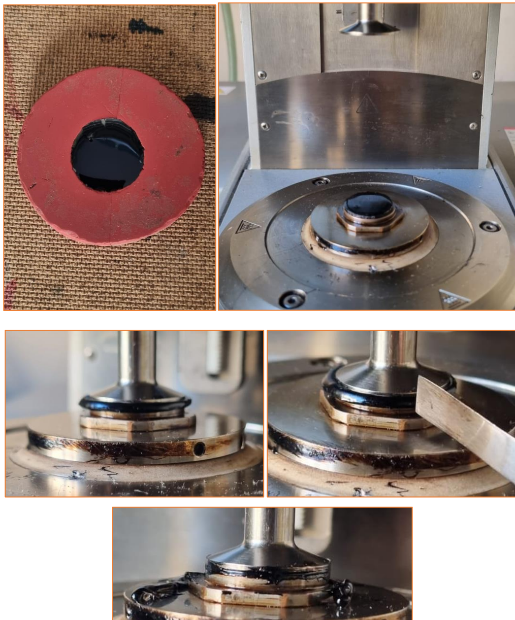
Figura 38: 1) Provino MSCR liquido; 2) Provino con piatto inferiore e superiore; 3) fase di “schiacciamento del provino”; 4) fase di “trimming”; 5) provino ultimato;
