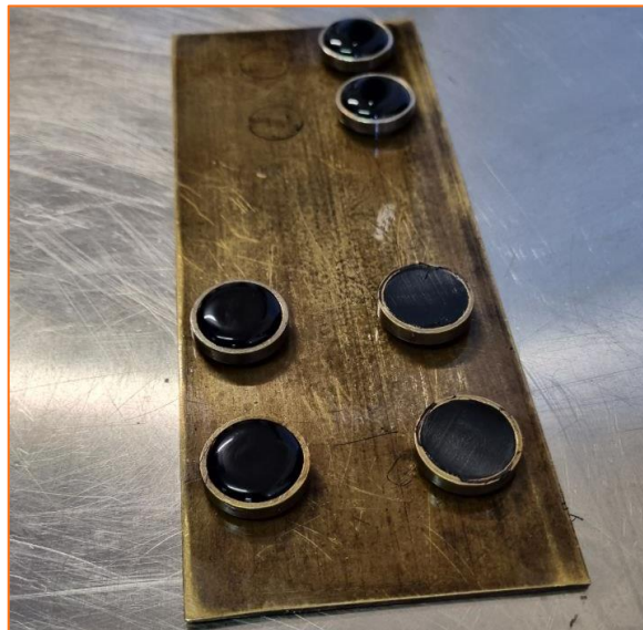
Figura 23: preparazione dei campioni da utilizzare nel Ring and Ball test
