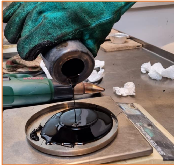
Figura 28: travaso di bitume invecchiato al RTFOT nel piattino del PAV
