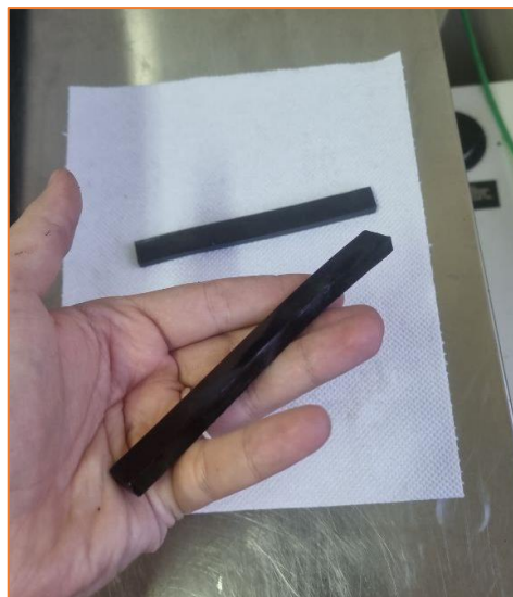
Figura 34: Travetto di bitume (dopo il test);
