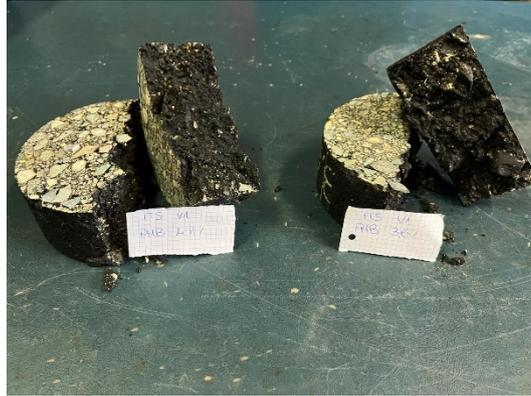
*Figura 63: particolare della rottura di due campioni post ITS*
