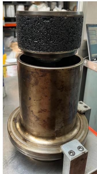
*Figura 46: estrazione del provino compattato*
