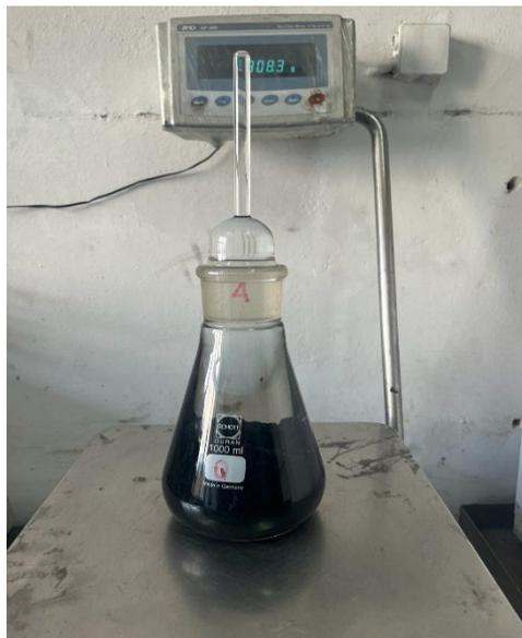
*Figura 39: massa del picnometro con tappo, campione ed acqua fino al menisco (m3)*
