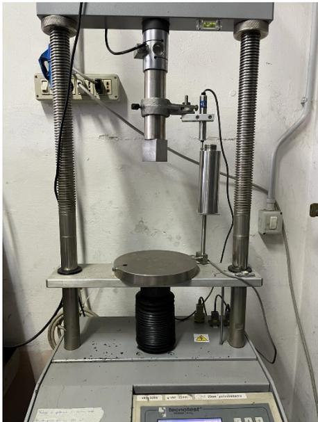
*Figura 60: macchinario di prova per ITS*
