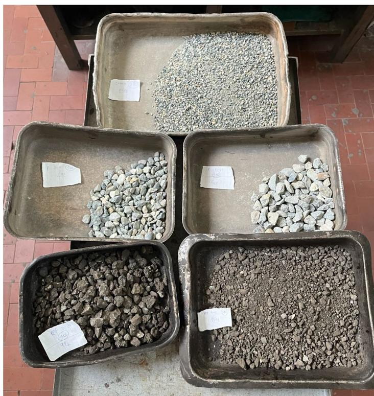
Figura 23: preparazione dei quantitativi di aggregati da “ricetta”
