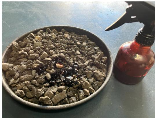
*Figura 16: esempio di applicazione del rejuvenator*
