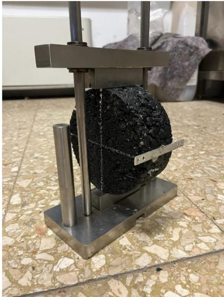
*Figura 66: inserimento del campione nel castelletto di prova*
