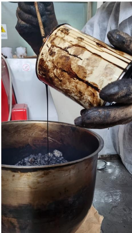
*Figura 27: aggiunta del bitume vergine*
