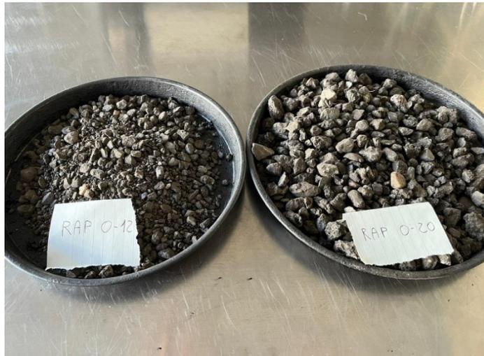
*Figura 12: classi granulometriche di fresato*
