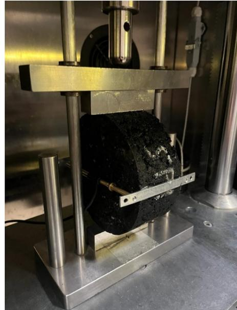
*Figura 67: inserimento sotto il pistone di carico con trasduttori*
