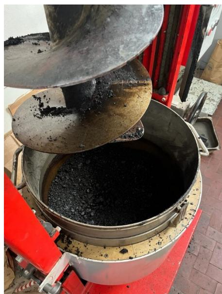
*Figura 25: risultato della miscelazione meccanica*
