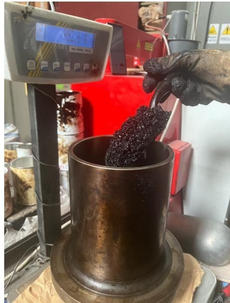
*Figura 45: caricamento della fustella con la miscela sciolta*
