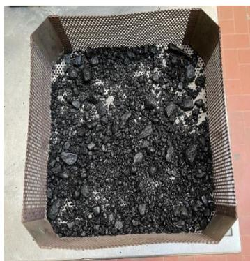
Figura 32: massa iniziale del campione + attrezzatura ( $W_s+t$ )
