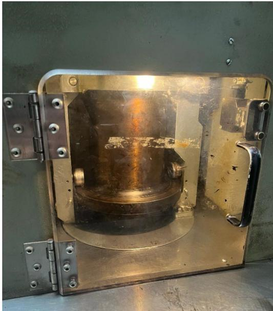
*Figura 47: compattazione tramite pressa a taglio giratoria*
