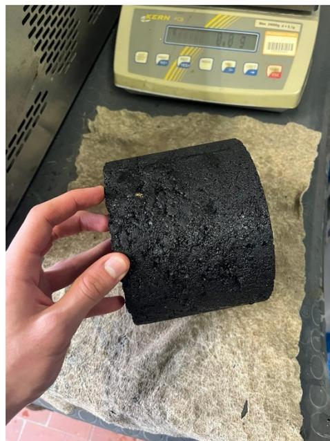
Figura 50: creazione della superficie saturo a superficie asciutta
