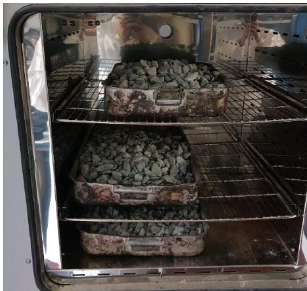
*Figura 22: fase di essiccazione degli aggregati vergini*
