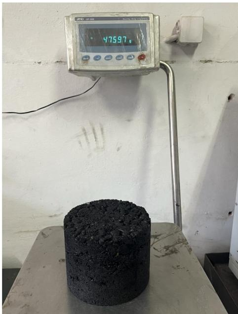
Figura 49: massa del provino asciutto (m1)
