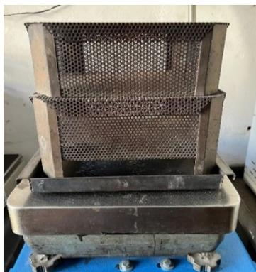
Figura 30: cestino di campionamento e vassoio di raccolta
