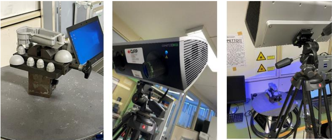
Figure 3.6, 3.7, 3.8: Posizionamento del pezzo (foto sx), scanner utilizzato (foto centrale), scannerizzazione del pezzo (foto dx)
