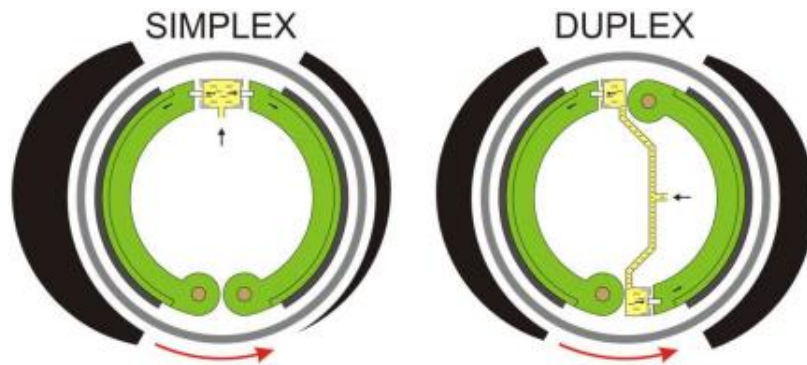
Figura 1.3 Schema del funzionamento simplex e duplex
