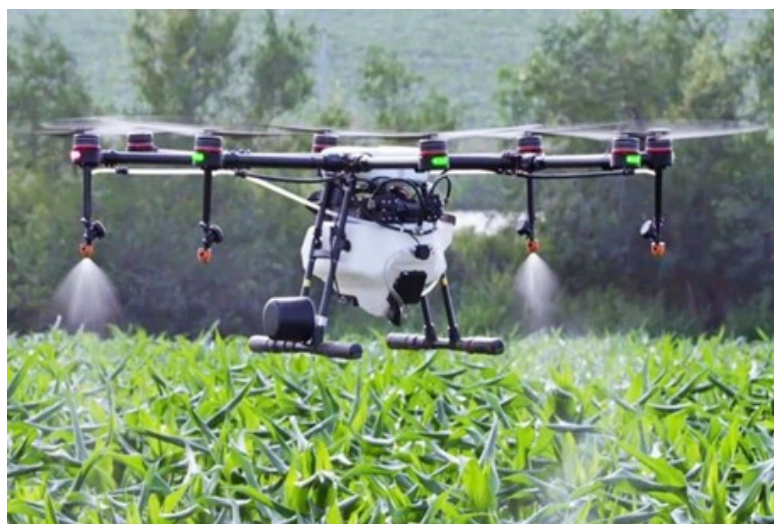
Figura 2.13: Drone che spruzza soluzione fitosanitaria
