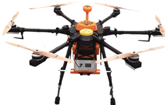
Figura 2.12: Drone esarotore Nimbus[20]
