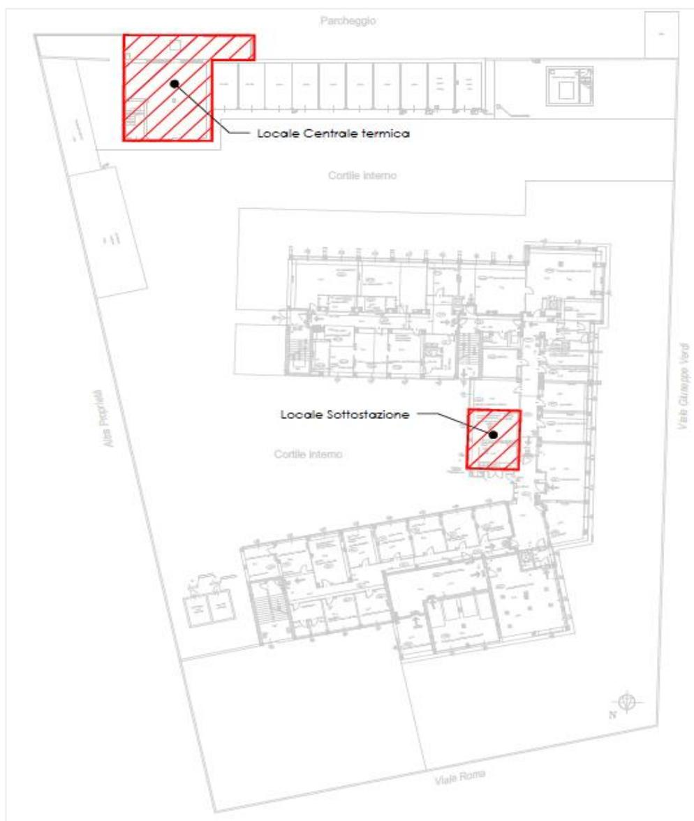
Figura 25 - Planimetria con posizionamento della centrale termica e della sottocentrale [17]
