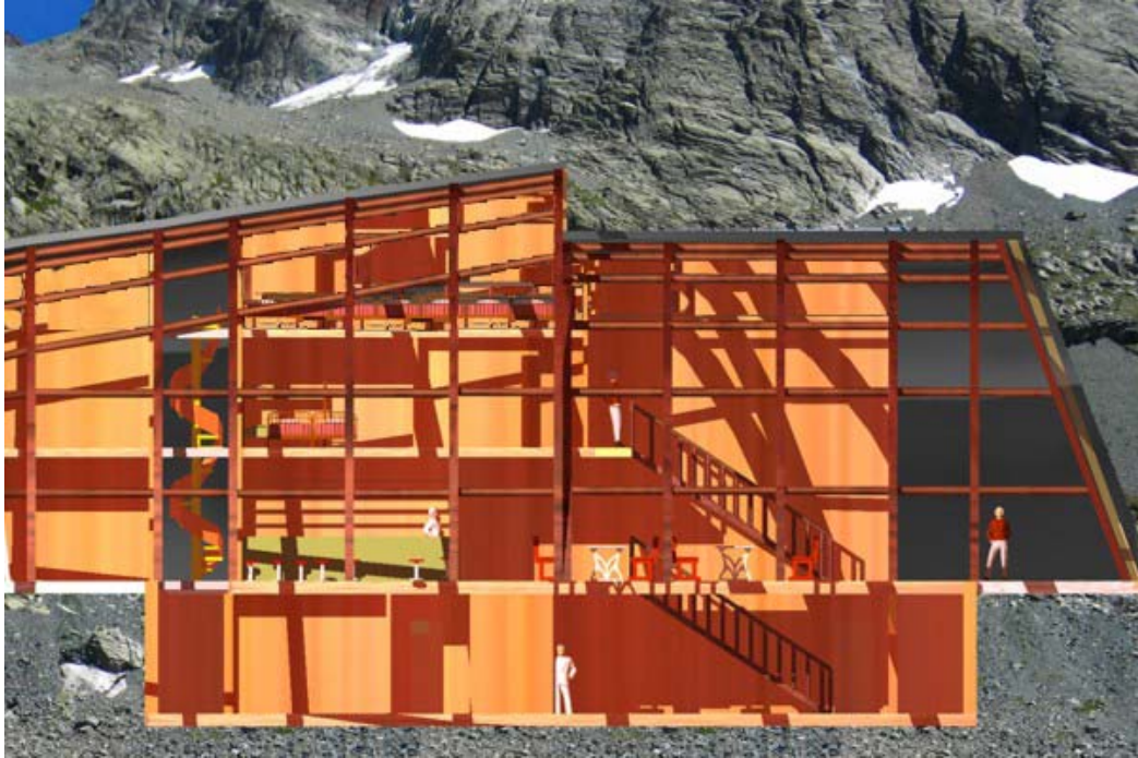
Sezione Longitudinale. Struttura, volumetrie
