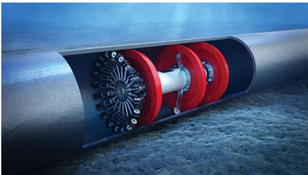
Figura 21: Attività di pigging in una condotta sottomarina [64]
