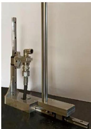
**Figura 11 - Foro di rilascio con ostacolo che ostruisce il moto**
