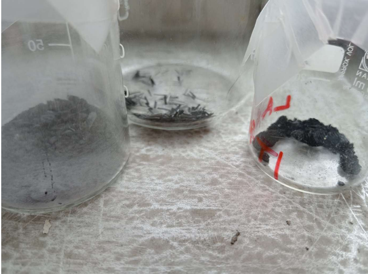
Figura 30 – Allotropi funzionalizzati (da sinistra a destra: Grafene-Fibre-Nanotubi)
