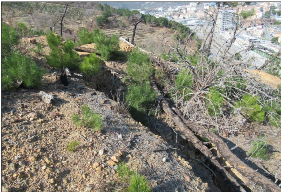
*Figura 3.26: Trench che ha causato il ribassamento del terreno a monte dell'area doganale.*
