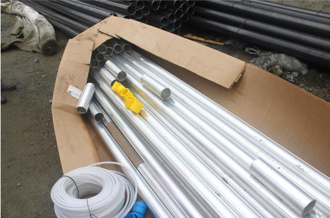
*Figura 8.7: Tubi inclinometrici.*
