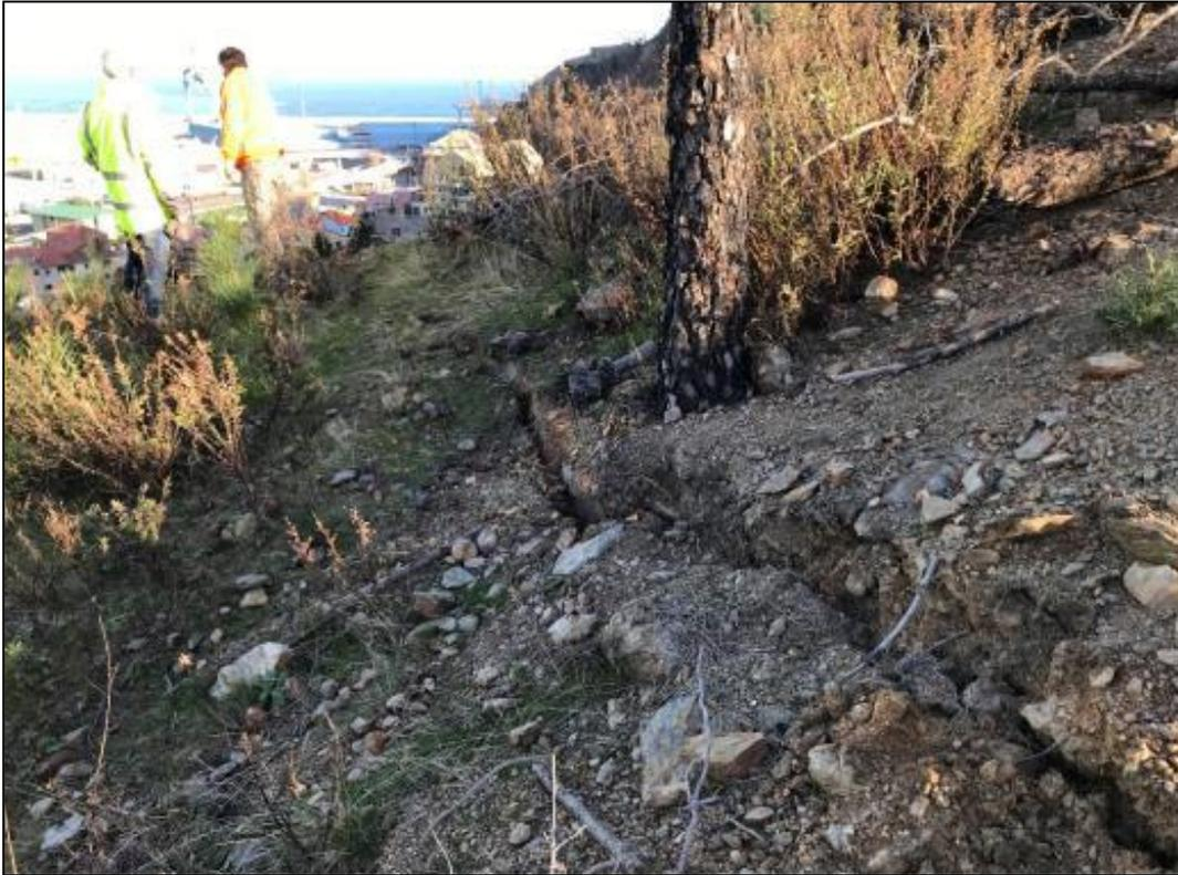
*Figura 3.19: Particolare del terreno ribassato con presenza di fessurazioni da trazione.*
