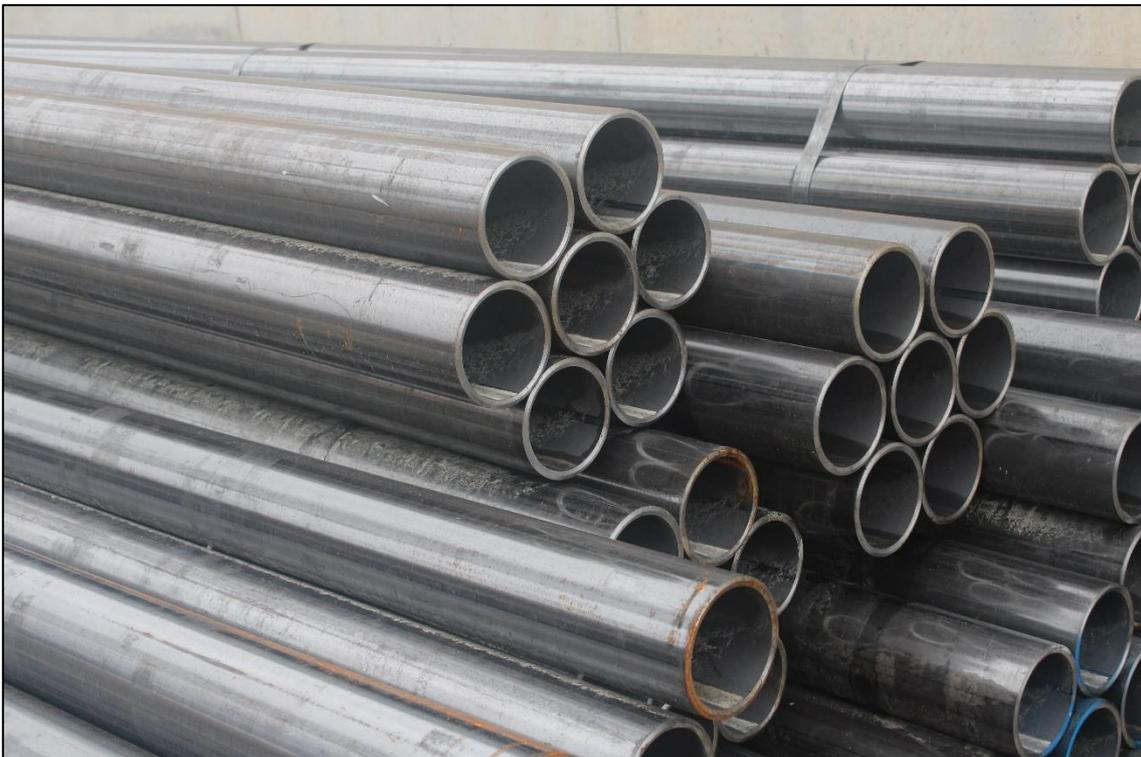
*Figura 8.8: Micropali utilizzati per la realizzazione delle paratie.*
