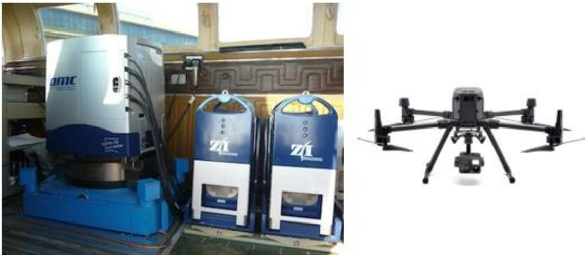
*Figura 2.8, sensori fotografici montati a bordo di aerei e APR (DJI Matrice 300).*
