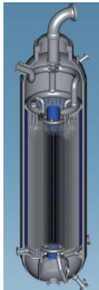
Figura 2.18 Reattore per grandi produzioni di metanolo, tratto da [18].
