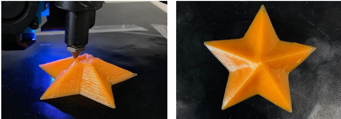
Figura 4.30 Piramide con base a stella ottenuta attraverso il processo di stampa 3D della miscela di NC 547 e DGEBA con 7% di MFC: a sinistra il processo di stampa e a destra il pezzo al termine del processo
