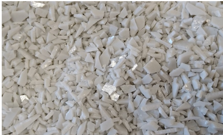
Figura 19: frammenti delle piastre ottenuti per macinazione con il granulatore Piovan.
