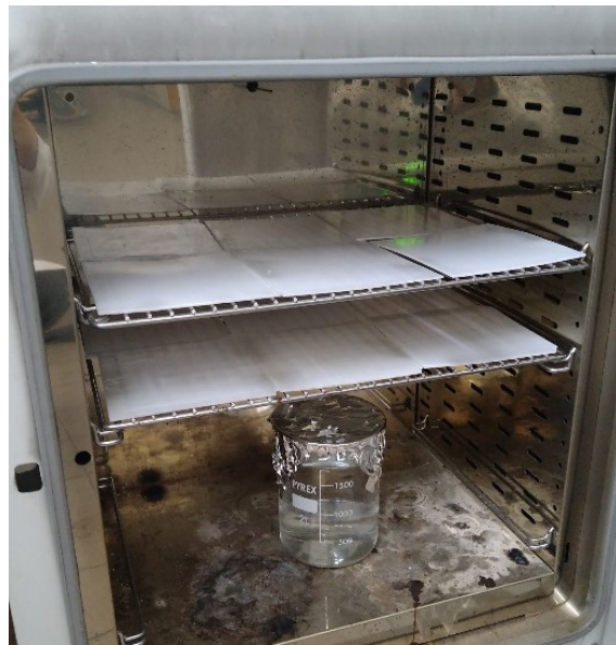
Figura 17: disposizione delle piastre all'interno della stufa.
