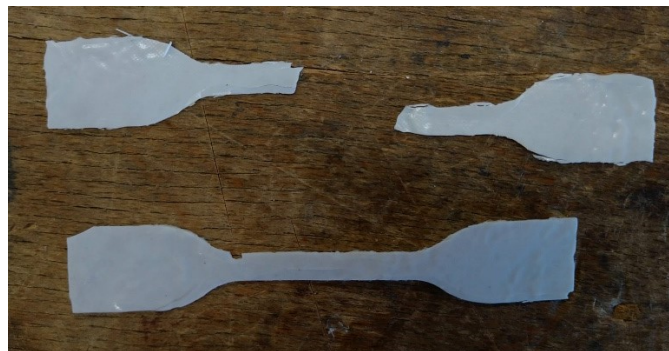
Figura 21: provini ottenuti per fustellatura con testa a geometria ad osso di cane.
