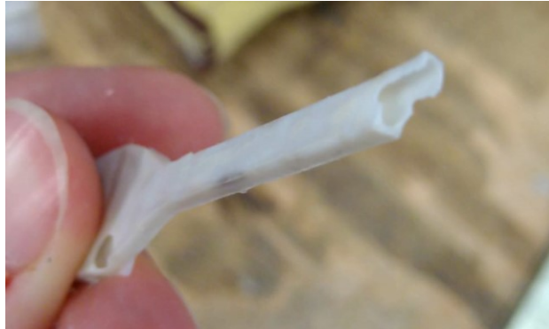
Figura 20: porosità interne ai provini a geometria ad osso di cane ottenuti per pressatura a caldo.
