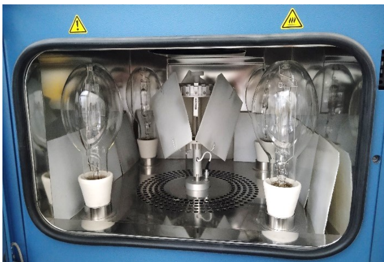
Figura 16 : disposizione reale delle piastre all'interno della camera dello strumento SEPAP 12/24.
