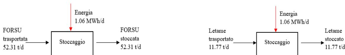
**Figura 3.3.** Flussi di materia ed energia - sezione di stoccaggio dei substrati
