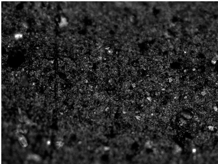
Figura 52: ingrandimento 100x SEBS commerciale
