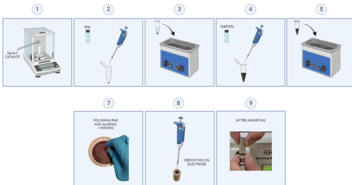
Figura 9. Preparazione dell'inchiostro catalitico da testare in RRDE
