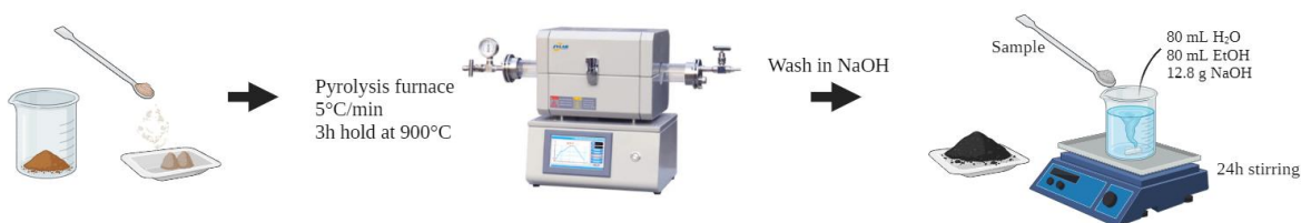
Figura 6. Prima pirolisi e lavaggio in NaOH
