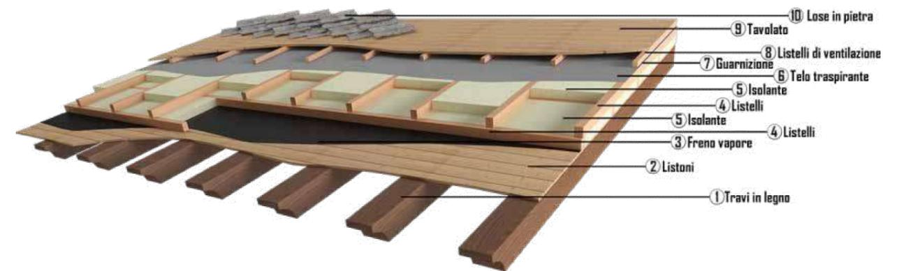
Fig. 36. Esempio di coibentazione in estradosso di un tetto costruito ex-novo. Nell'immagine viene proposta una stratigrafia ottenuta dal sito [www.borneylegnami.com](http://www.borneylegnami.com), rispetto alla stratigrafia originale è possibile notare un ispessimento della falda per poter contenere l'isolante.
