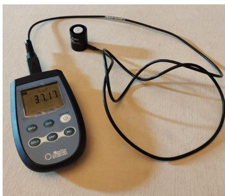
**Figura 3** - Fotoradiometro Delta Ohm serie HD 2302.0 con sonda fotometrica per la misurazione dell'illuminamento, utilizzato per le verifiche in campo.
