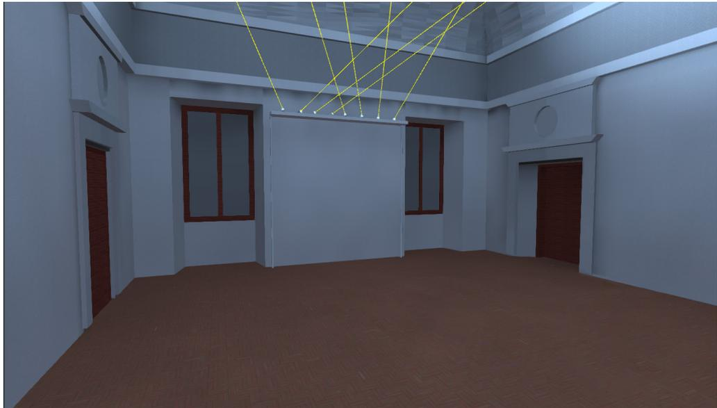
**Figura 5** - Puntamenti realizzati sul software Dialux. Sala della Caccia
