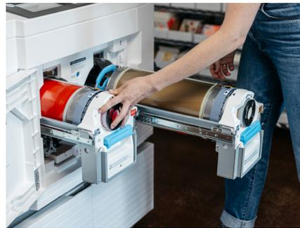
FIG.85 Stampante risograph a cilindri colore
