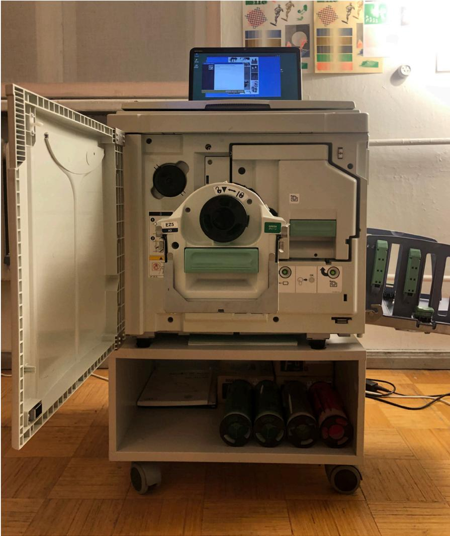
FIG.91 Stampante risograph con sportello posteriore aperto e vista sul cilindro
