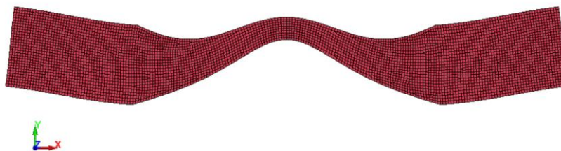
Figura 40: modo di vibrare a flessione nel piano del provino hourglass
