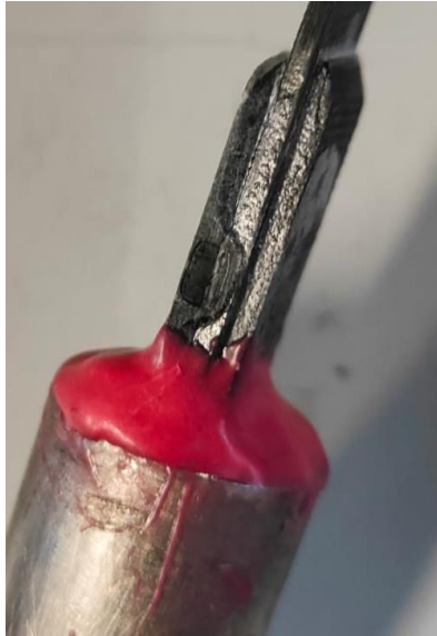
Figura 93: rottura adesivo e tab nel provino 4D s
