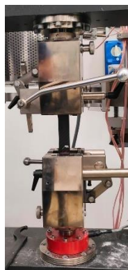
Figura 101: provino per prova di trazione all'interno della macchina Zwick Roell Z050
