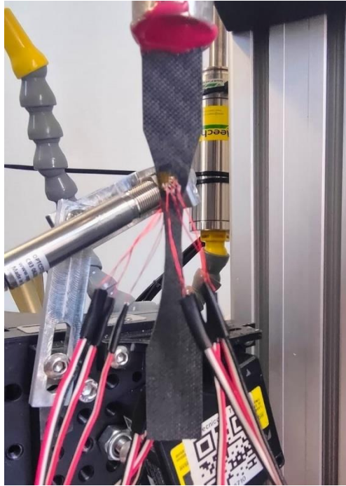
Figura 29: provino hourglass con rosetta applicata
