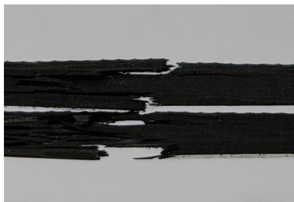
Figura 115: ingrandimento delle superfici di frattura dei due provini hourglass q.i. testati staticamente
