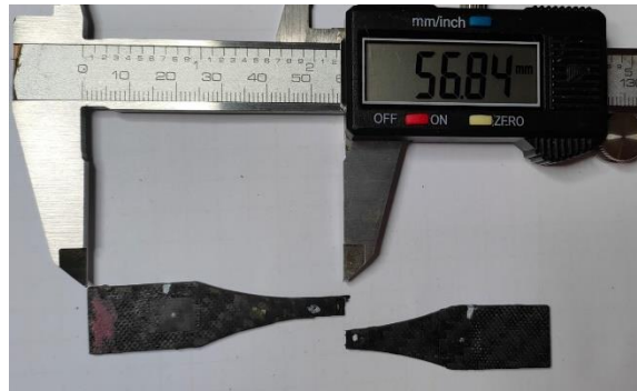
Figura 111: posizione di rottura dell'hourglass nel caso quasi statico
