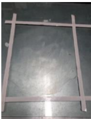
Figura 51: lastra con sealant tape applicato e cera distaccante passata
