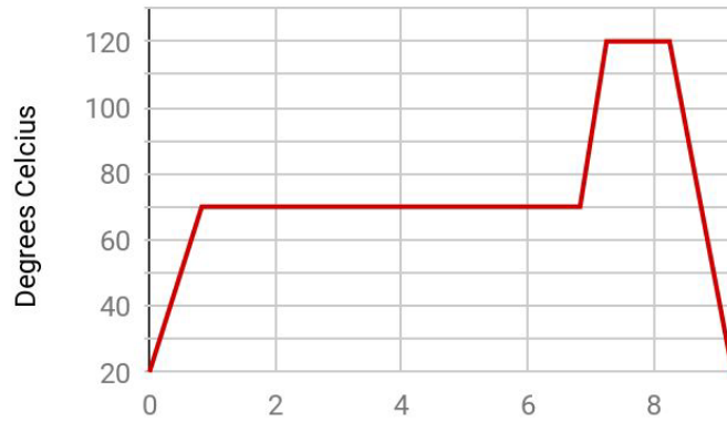
Figura 47:ciclo di cura di XC110 210g 2x2 Twill 3k Prepreg Carbon Fibre [26]
