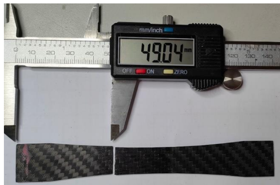
Figura 112: posizione di rottura dello smooth hourglass nel caso quasi statico
