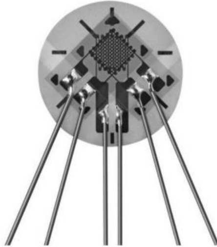
Figura 28: rosetta utilizzata (C2K-XX-G1350/SP70*) [21]
