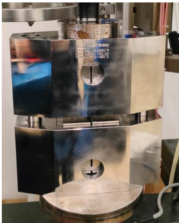
Figura 103: afferraggio con dispositivo anti-buckling
