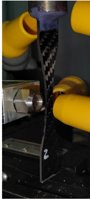
Figura 116: raffreddamento dei provini hourglass quasi isotropi testati a fatica
