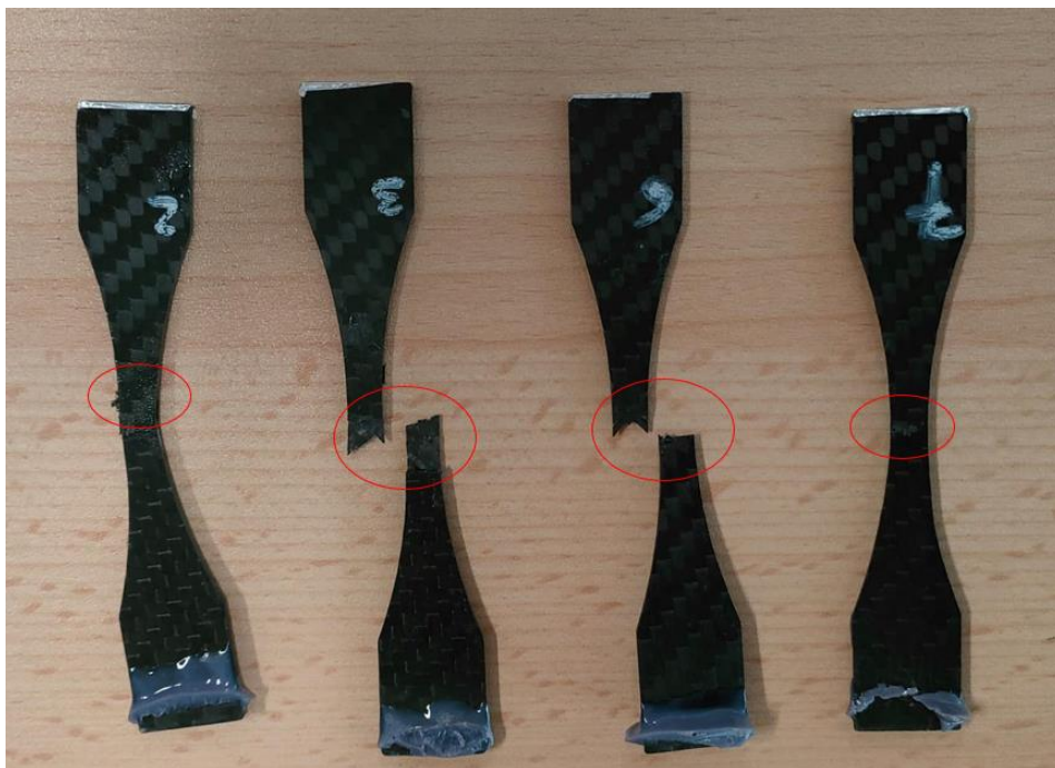
Figura 117: provini hourglass q.i. testati a fatica, rotti al centro
