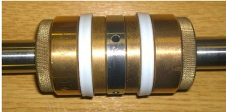
Figura 4.6 - Foto di cilindro pneumatico con guarnizioni e foro di scarico.
