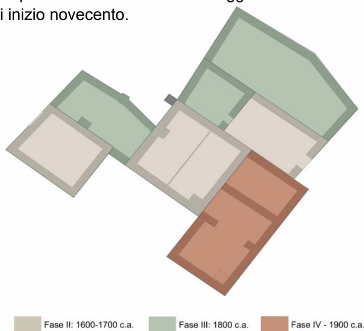
Schema dell'ipotesi di ampliamento dell'edificio n.2
