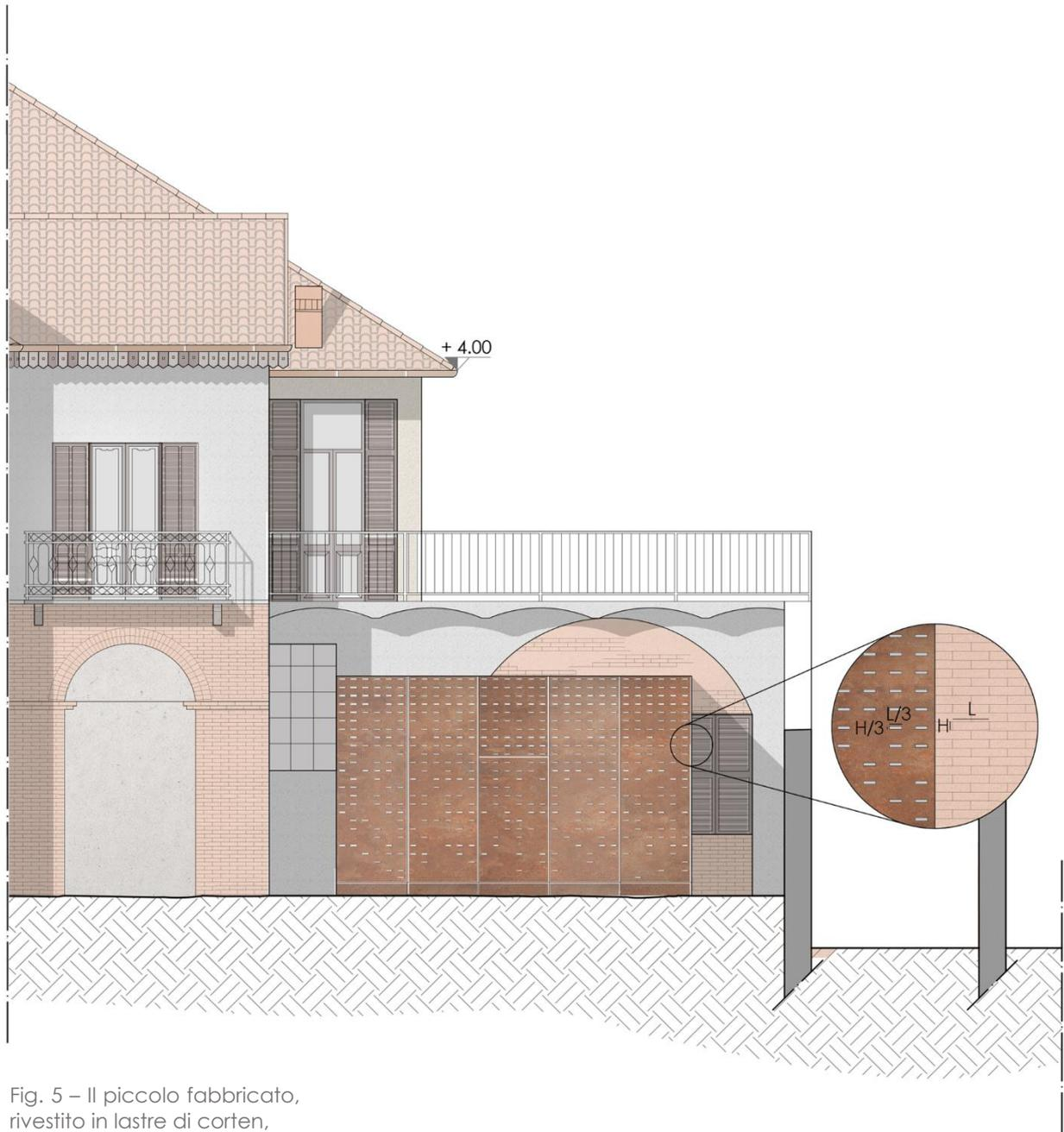
Fig. 5 – Il piccolo fabbricato, rivestito in lastre di corten, del vano scala e ascensore di collegamento al parcheggio interrato. Estratto del prospetto nord, fuori scala.
