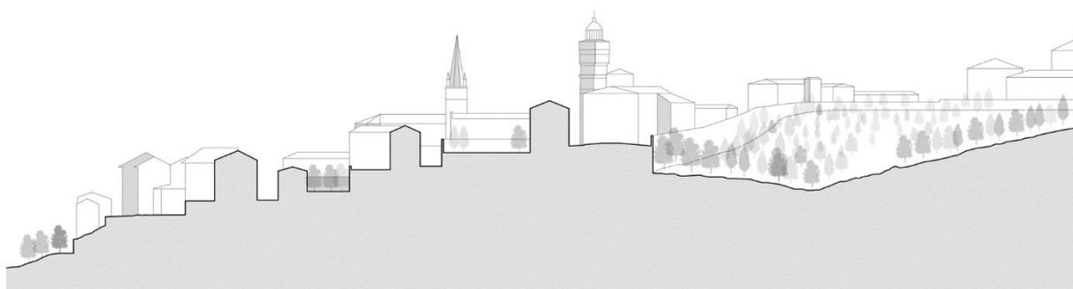
Fig. 4 – Sezione trasversale del borgo di San Martino. Il dislivello della collina impone di realizzare gli edifici su terrazzamenti.
