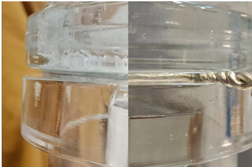
*Figura 2.7 – Dettaglio posizionamento filo di indio tra le due metà della campana*
