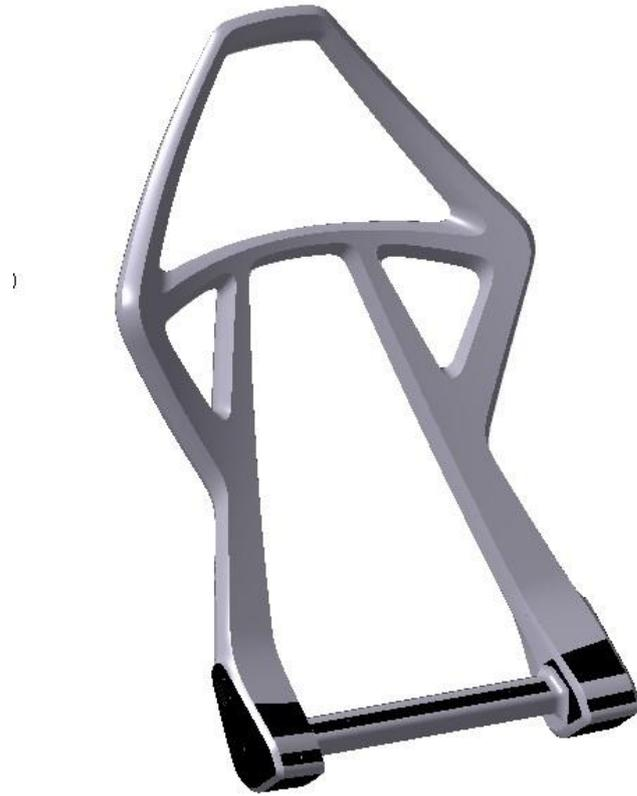
*Figura 23. Design finale della struttura tubolare del sedile*
