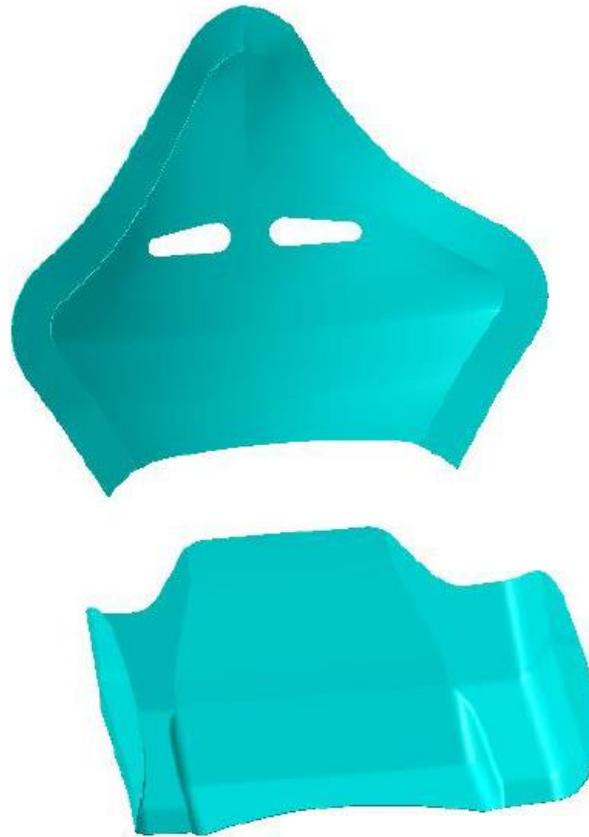
*Figura 17. Design delle scocchette dello schienale*
