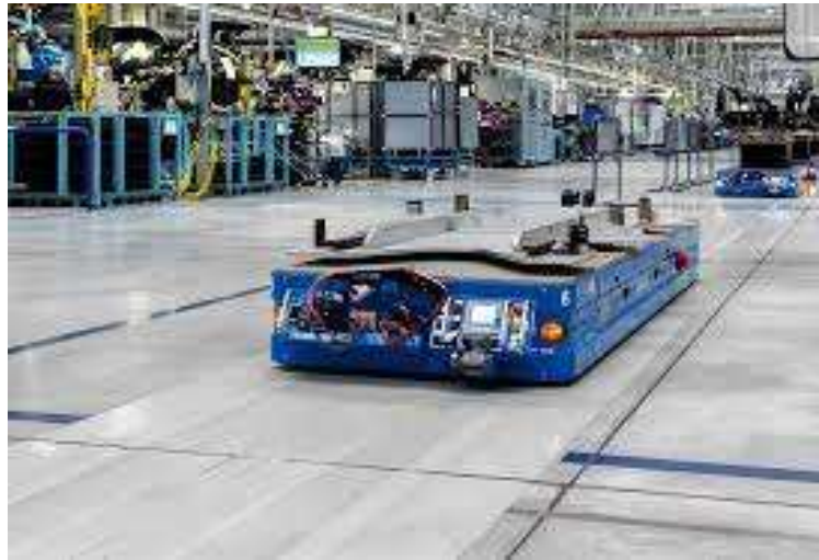
Figura 2 - Esempio AGV utilizzati
