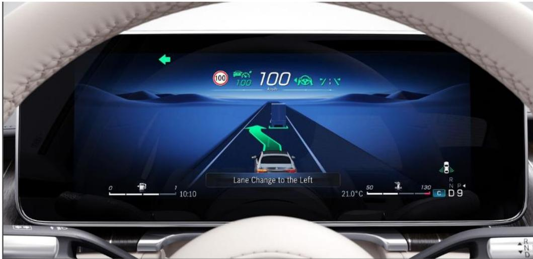
*Figura 8: esempio di interfaccia ADAS (mercedes-benz.com)*
