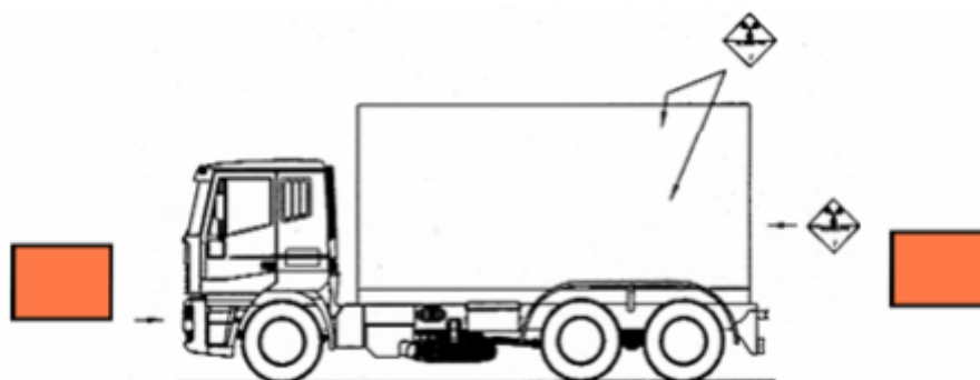
Figura 8: marcatura di un veicolo trasportatore di merci pericolose delle classi 1 e 7
