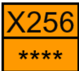
Figura 6: numero di Kemler rappresentante un materiale che reagisce pericolosamente con l'acqua
