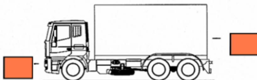
Figura 3: marcatura di un mezzo trasportante merci pericolose (escluse quelle delle classi 1 e 7) [13]
