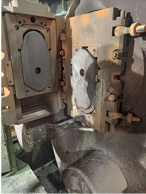
*Figura 14 - Cassetto con all'interno la piastra fissa (sinistra) e la piastra mobile (destra)*
