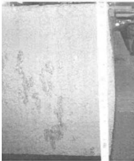
Figura 34 - Rigonfiamento della faccia di una bramma
