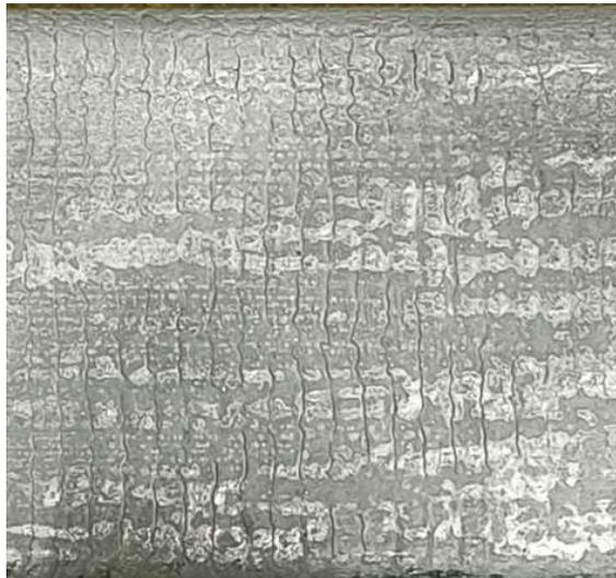
*Figura 45 - Fotografia di una billetta di F316L dopo essere stata decapata*
