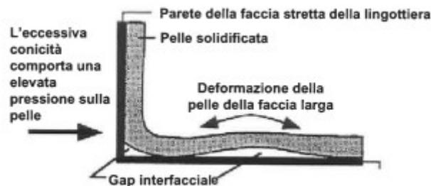
Figura 21 - Depressione longitudinale causata dalla conicità troppo elevata
