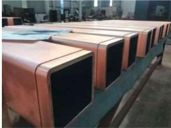
*Figura 9 - Lingottiera di colata continua a sezione quadrata*
