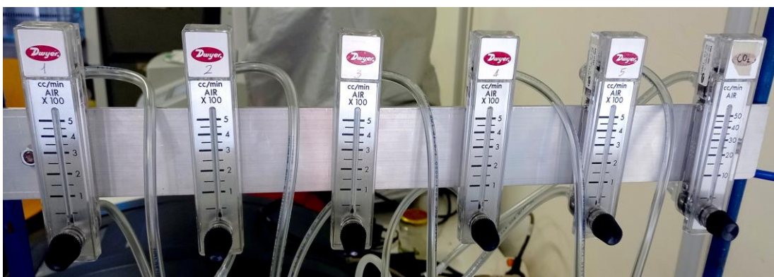
Figura 3.2.3: Immagine dei flussometri sintonizzabili presenti nel sistema impiantistico di laboratorio usato per la coltivazione di Chlorella Sorokiniana SAG 211-8k.
