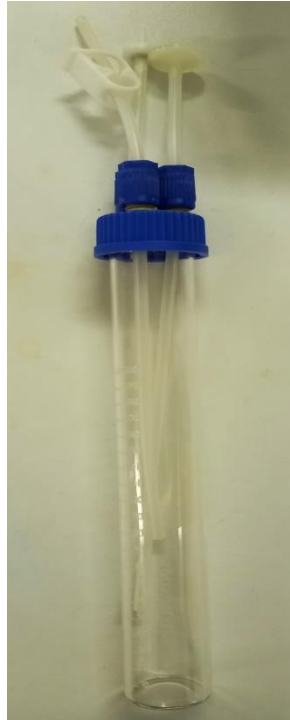
Figura 3.2.2: Immagine del fotobioreattore di laboratorio usato per la coltivazione di Chlorella Sorokiniana SAG 211-8k.
