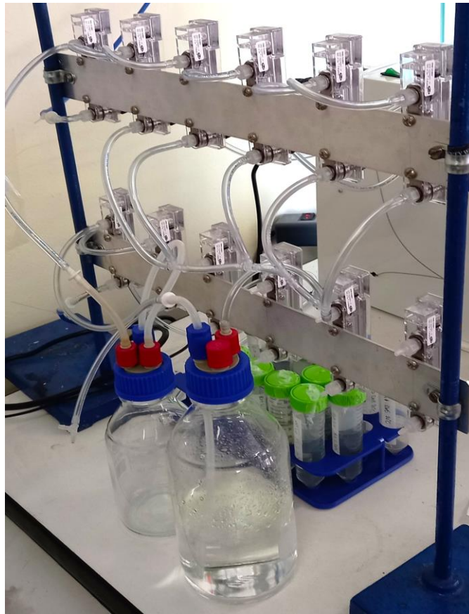
Figura 3.2.4: Immagine del sistema di miscelazione e umidificazione dell'aria in ingresso ai PBRs.
