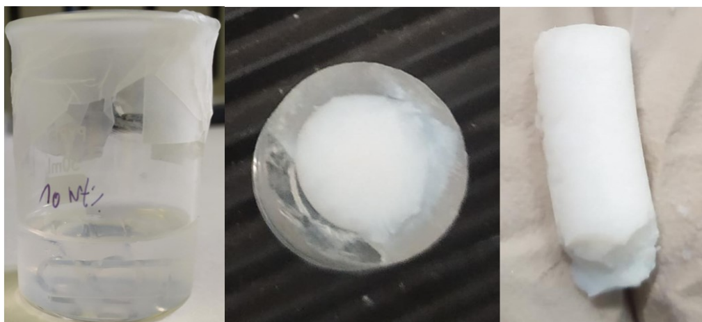
Figura 4.6: A sinistra la fase di invecchiamento, al centro e a destra ASCD_10_40 un campione dopo la fase di essiccamento.
