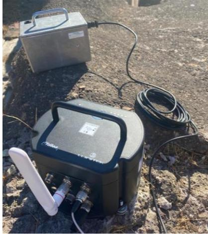
Fig. 1-2. Triton accelerogram used in SHM tasks at Politecnico di Torino.
