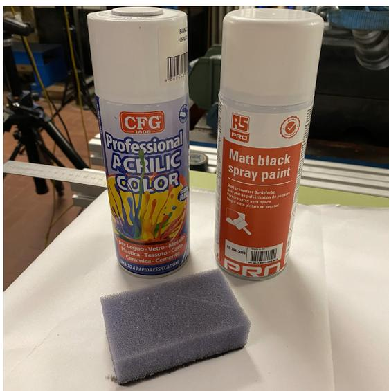
(a) Vernice e spugna utilizzate per la realizzazione del pattern su schiuma
