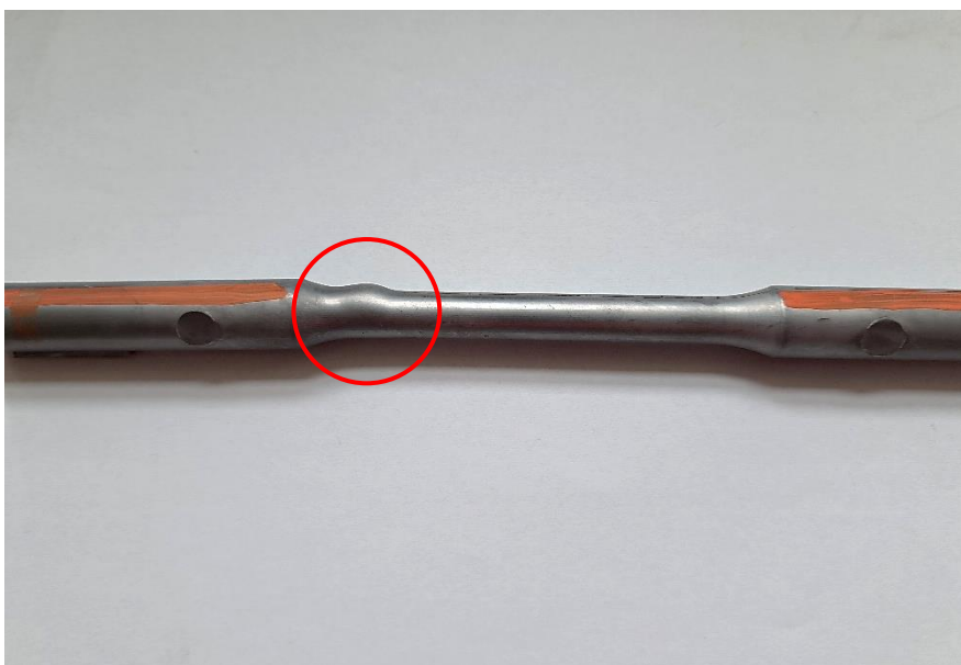
Figura 16 - Esempio vistoso di blistering su un provino da pressocolata
