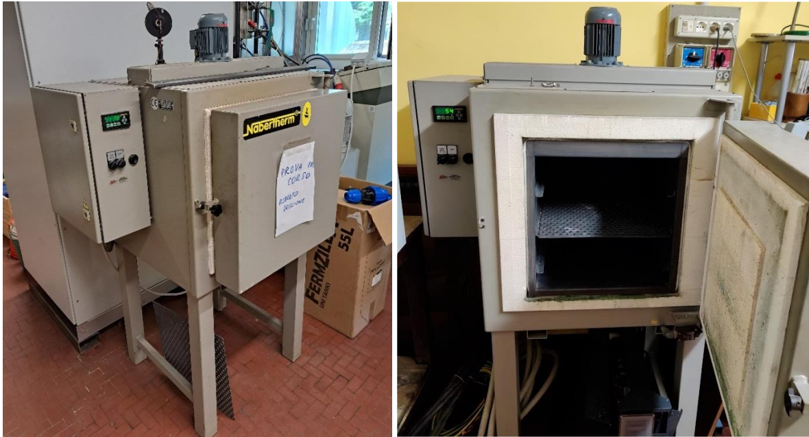
Figura 15 - Forno utilizzato per il trattamento termico dei provini
