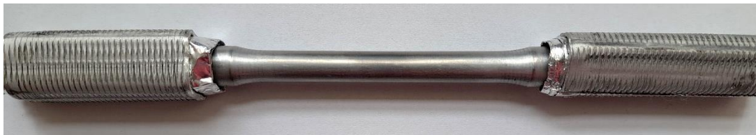
Figura 31 - Accorgimento introdotto per arginare il fenomeno di "fretting fatigue"
