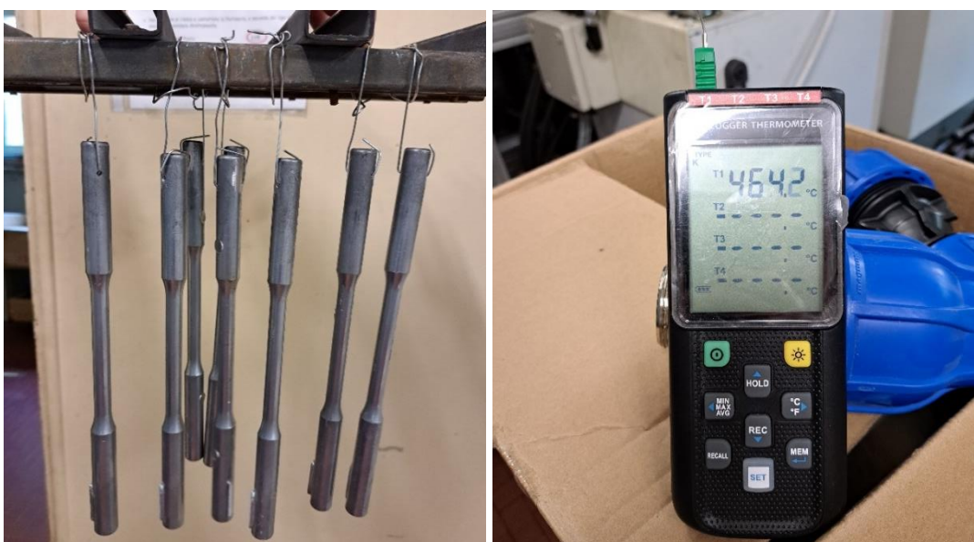
Figura 14 - Set-up sperimentale (telaio per provini e output termocoppie)
